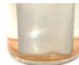
市販品1 腐食あり
