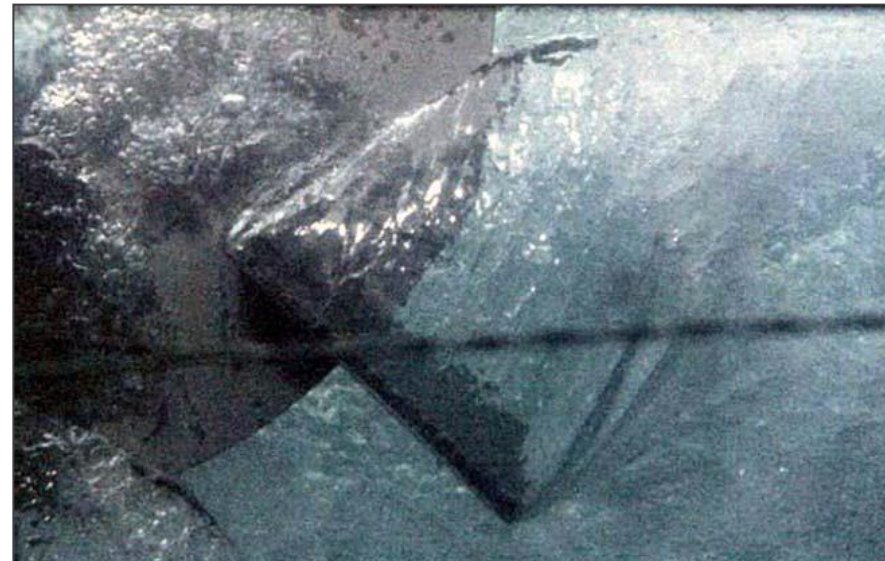
ラージキャビティ発生状況 ( P_{gV}=1.5 \text{ kW/m}^3 , 1 vvm)
